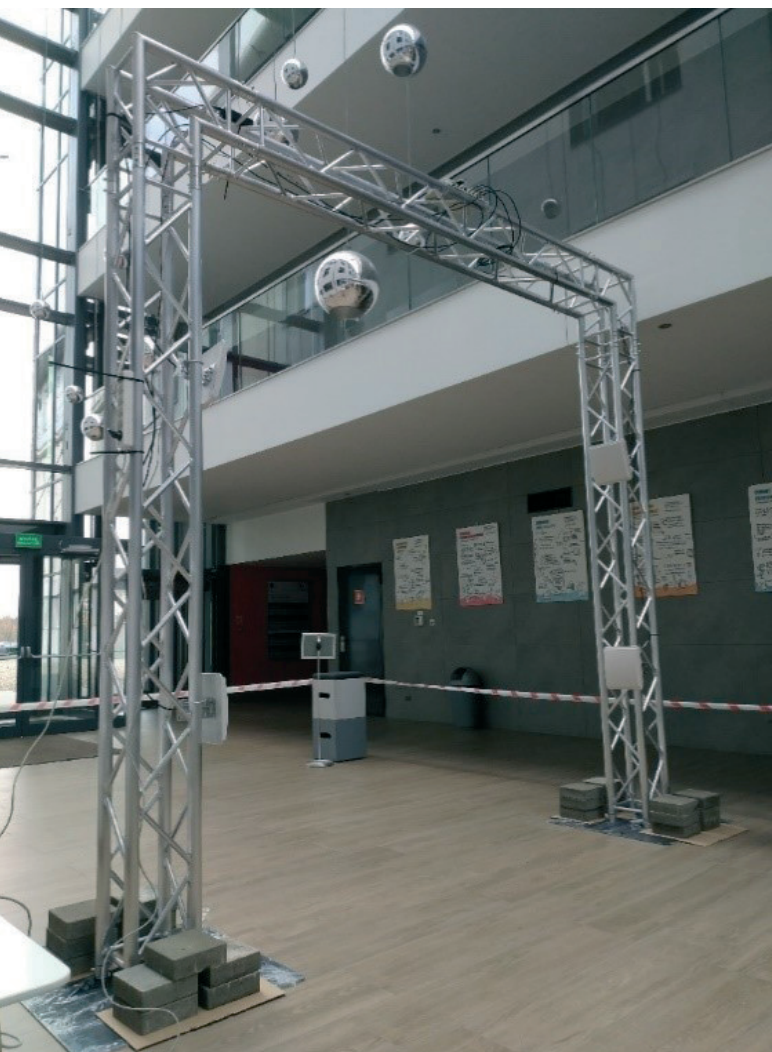
Rys. 3 Konstrukcja kratownic dla bramy RFID
